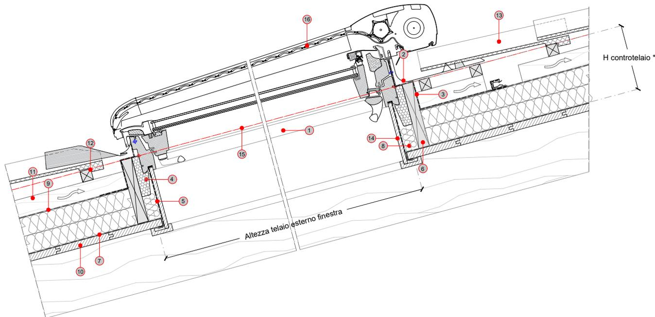
\* H controlaio = altezza della stratigrafia del tetto, dalla base di appoggio fino alla linea di posa del manto di copertura (linea rossa di posa della finestra per tetti VELUX)
