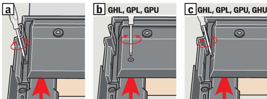
**ITALIANO:** Allentare le viti del rivestimento superiore **a**, **b** o **c**. Reinstallare i rivestimenti della finestra utilizzando le viti esistenti. Riavvitare le viti precedentemente allentate.
