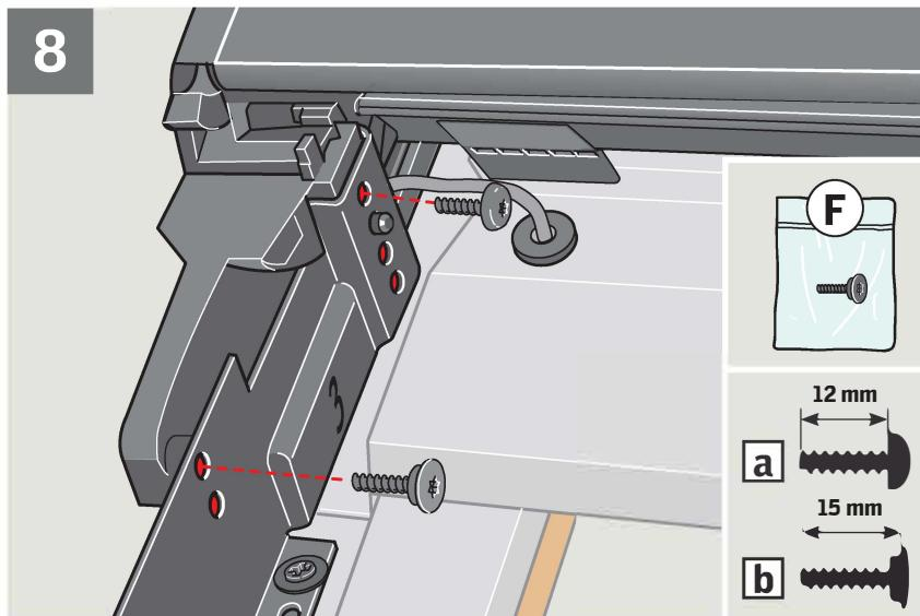
**ENGLISH:** Fit securing screws **a**, **b**.**DEUTSCH:** Sicherungsschrauben montieren **a**, **b**.**FRANÇAIS :** Positionner et serrer les vis de sécurité **a**, **b**.**DANSK:** Sikringsskruer monteres **a**, **b**.**NEDERLANDS:** Plaats de veiligheidsschroeven **a**, **b**.**ITALIANO:** Fissare le viti di sicurezza **a**, **b**.**ESPAÑOL:** Coloque los tornillos de seguridad **a**, **b**.
