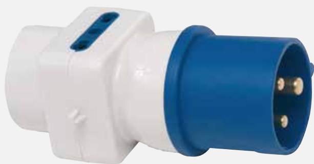
Adattatore spina: CEE 3-polig 230 V/16 A, prese: 2 x IT 230 V/ 10/16 A + 1 x DE 16 A
