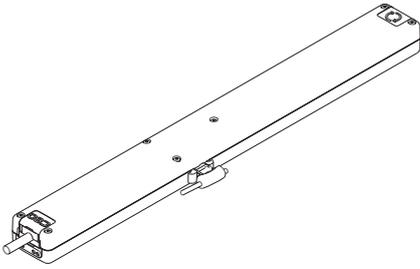
**C60 configurato per applicazione a sporgere con montaggio frontale**
