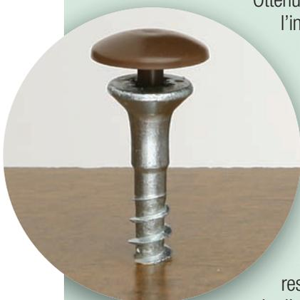
Ottenuto con un particolare procedimento produttivo, il foro permette l'incastro del perno di un cappuccio particolarmente **spesso e lungo**, a garanzia di una **solida tenuta** di quest'ultimo anche in caso di testa della vite particolarmente "annegata".
