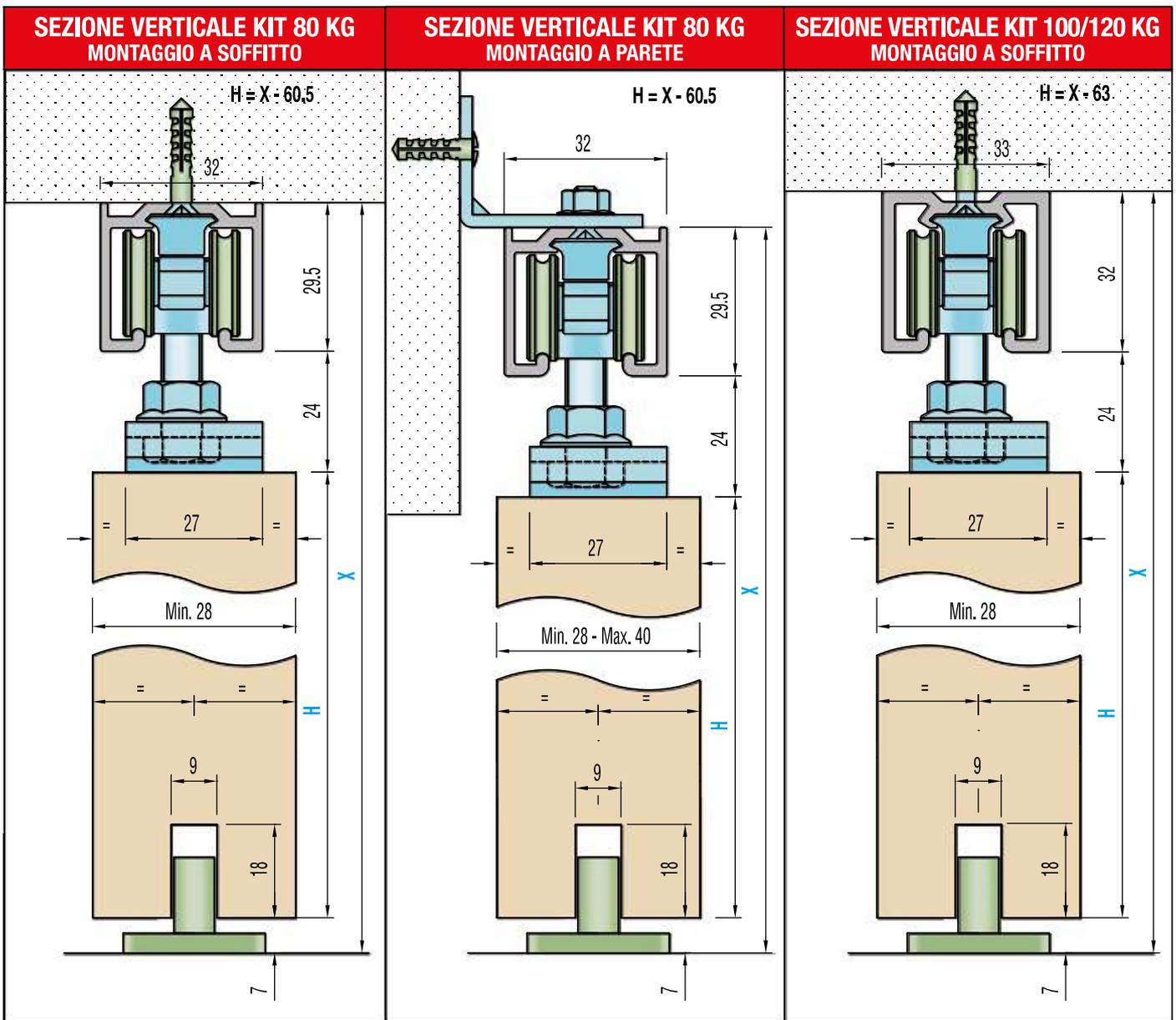
**Schema di fissaggio carrelli**
