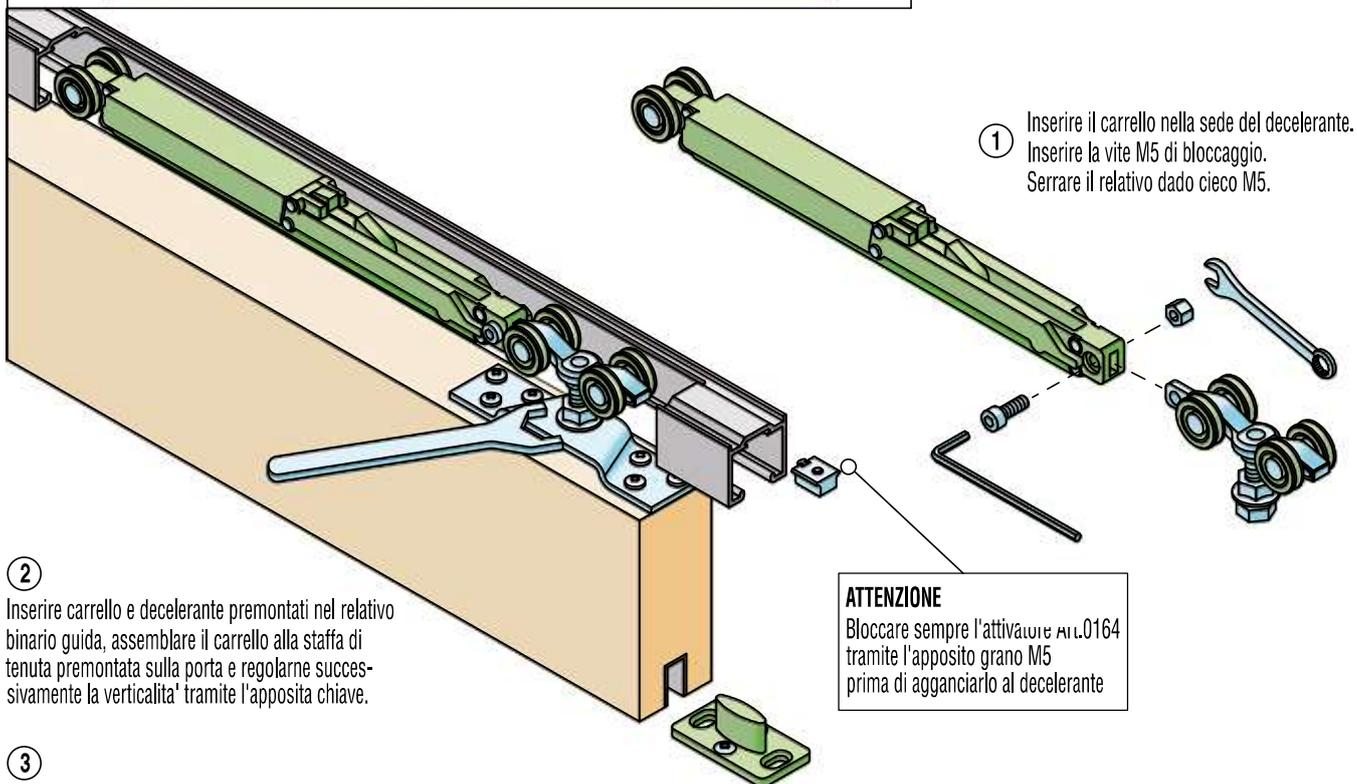
② Inserire carrello e decelerante premontati nel relativo binario guida, assemblare il carrello alla staffa di tenuta premontata sulla porta e regolarne successivamente la verticalità tramite l'apposita chiave.
