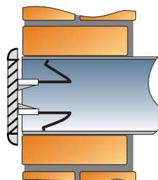
LA VENTILAZIONE ha studiato griglie dotate di molle flessibili che, oltre ad adattarsi a vari diametri di tubi e alle imperfezioni di fori nel muro, consentono una rapida installazione e la possibilità di rimuovere comodamente la griglia. È pertanto sconsigliato l'utilizzo di malte, stucchi, collanti e siliconi che impedirebbero la dovuta manutenzione.
