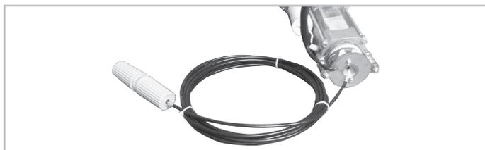
Utilizzato da tutte le versioni JOLLY quale sicurezza in presenza di una serranda con molle usurate. Alimentato con il motore, è dotato di cavetto, guaina e pomello di sblocco in caso di mancanza di corrente. cod. ACJ9015
