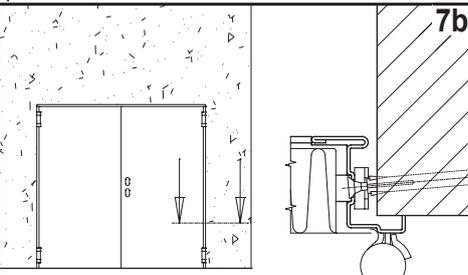
Tassellare il traverso del telaio in corrispondenza dei fori predisposti sotto la guarnizione termoespendente, utilizzando tasselli Würth art. 0910436112 (non in dotazione). Montare l'anta attiva e controllare che le due ante siano posizionate sulla stessa quota (vedi punto 2). Rimuovere le squadrette liberando l'anta passiva. È tassativo riavvitare le due viti (part. 4a, fig. 4) sia in alto che in basso all'anta passiva. Fissare la restante parte del telaio.
