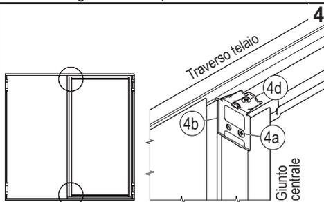
Per facilitare l'operazione seguente allentare le viti (4a) prefissate delle squadrette (4b) poste in alto e basso del giunto centrale. Consolidare i due traversi all'anta passiva avvitandoli con le viti (4d) in dotazione nella scatola maniglia. Fissare bene tutte le viti.
