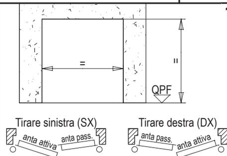
Sballare i materiali, togliere dal retro del telaio la guarnizione FC che servirà per l'operazione della fig. 9. Verificare la corrispondenza delle misure della porta al foro muro e il senso di apertura. Verificare che la parete sia del tipo in blocchi, in muratura o in calcestruzzo omogeneo con una densità di 1200±400 kg/m<sup>3</sup> ed uno spessore di min. 150mm.
