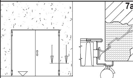
Montare l'anta attiva e controllare che le due ante siano posizionate sulla stessa quota (vedi punto 2). Bloccare provvisoriamente la porta, a piombo nel foro muro, rispettando la QPF ed il parallelismo alla parete e fissare le zanche con malta a presa rapida. A fissaggio consolidato, rimuovere le squadrette liberando l'anta passiva. È tassativo riavvitare le due viti (part. 4a, fig. 4) sia in alto che in basso all'anta passiva.
