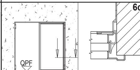
Piegare adeguatamente le zanche, inserire e bloccare provvisoriamente la porta, a piombo nel foro muro, rispettando la QPF ed il parallelismo rispetto alla parete.
