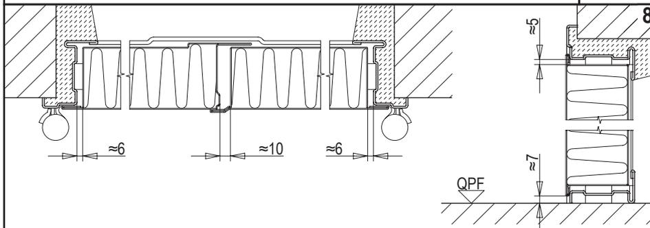
Riempire il vuoto tra telaio e parete con malta cementizia evitando imbarcamenti, occultare il telaio con l'intonaco e controllare i giochi indicati.
