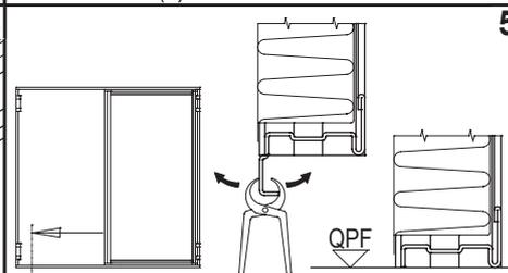
Una volta stabilito il livello del pavimento finito (QPF) e deciso che la porta dovrà essere senza battuta inferiore, staccare l'aletta sporgente del traverso inferiore così da appoggiare correttamente il profilo sul pavimento finito.
