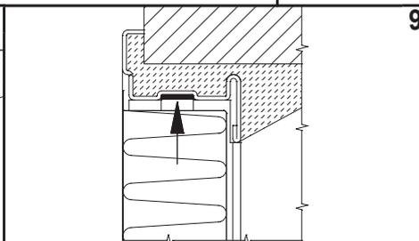
Togliere tutti i distanziali tra anta e telaio. Applicare la guarnizione termoespandente sul traverso superiore, tagliandola prima in due spezzoni nella misura che va dall'inserto-rotolo agli angoli opposti del telaio.
