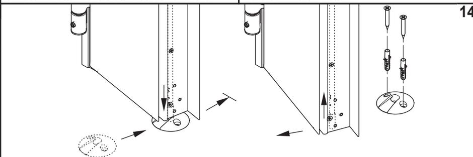
In assenza della battuta inferiore, posizionare la boccola a pavimento sotto all'anta passiva, chiudendola e facendo inserire l'asta inferiore nella boccola. Aprire l'anta senza muovere la boccola e tassellare quest'ultima al pavimento.
