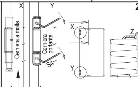
Applicare il montante telaio all'anta passiva infilando lo spinotto a molla (X) e avvitando i grani di bloccaggio (Y). Operazioni da eseguire con la massima attenzione e senza forzare. Applicare in alto e in basso (Z) i due distanziali in dotazione.
