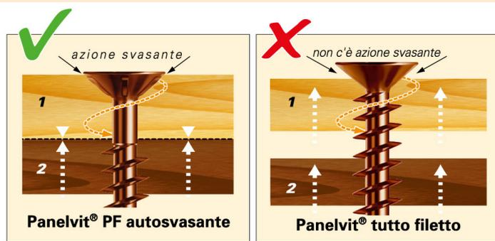
Il gambo liscio della vite ruota liberamente nella parte superiore (1). La filettatura opera sulla parte inferiore (2) avvicinandola alla prima.
