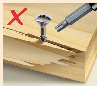
Avvitamento con vite truciolare tradizionale senza preforo.
