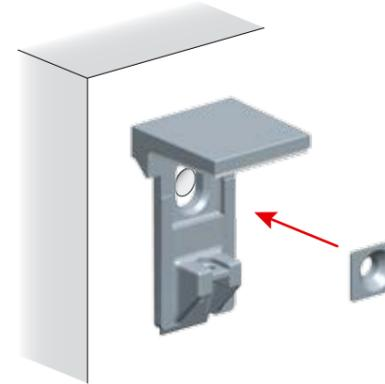
Fissare la forcella superiore utilizzando una vite TSP Ø5 ed un tassello adeguato alla parete di fissaggio
