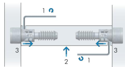
! Per il bloccaggio e lo sbloccaggio è sufficiente una rotazione di 90°
