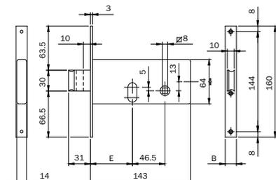
Serratura per fascia. CHIUSURA LATERALE. Funzionante con cilindro ovale.
