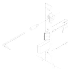
Elettroserratura da infilare a cilindro profilo europeo per fascia. **12Vac/dc**. CHIUSURA TRIPLICE.
