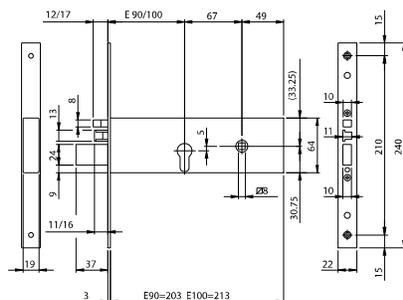
Elettroserratura da infilare a cilindro profilo europeo per fascia. **12Vac/dc**. CHIUSURA LATERALE.
