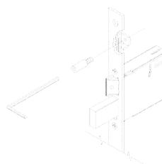
Serratura da infilare a cilindro profilo europeo per fascia. **MODULARE**. CHIUSURA TRIPLICE. Agganci aste a vite.
