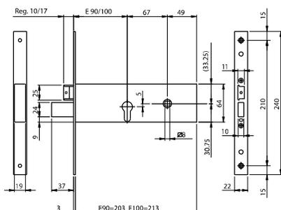
Serratura da infilare a cilindro profilo europeo per fascia. **MODULARE**. CHIUSURA LATERALE. Frontale INOX **240x22x3**.
