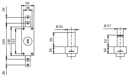
Serratura da applicare di sicurezza. **CHIUSURA DUPLICE**, verticale alto/basso, con foro predisposto per aggancio aste, escursione mm 26. **BUSSOLA GUIDA-CHIAVE INTERNA**. Due guida aste. Sbalzo mm 35 per aste. Incontro a cavalletto superiore. Boccola a pavimento. 3 CHIAVI A POMPA. Una impugnatura chiave in ABS. Cannotto antistrappo VERNICIATO  $\varnothing$  mm 33 per cilindro. Ghiera in ottone nichelato  $\varnothing$  mm 33. Viti di fissaggio.
