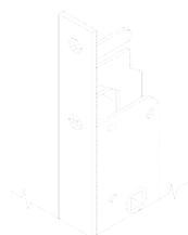
Serratura da infilare per montanti, CHIUSURA DUPLICE **ALTO/BASSO**, cilindro a profilo europeo.
