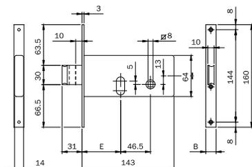
Serratura per fascia. CHIUSURA LATERALE. Funzionante con cilindro ovale.
