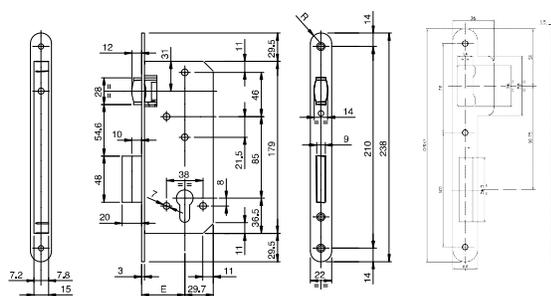
Serratura da infilare a **SCATOLA CHIUSA** funzionante con cilindro profilo europeo.
