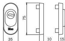
**GHIERA MODULARE** di protezione cilindro profilo europeo per serrature MULTIBLINDO E BLINDO fissaggio dall'interno. Ghiera, esterna e interna, **in alluminio.** Piastra esterna e dischetto antitrapano IN ACCIAIO CARBONITRURATO. Distanziatore piastra. Spessori. Viti. Sfere antitrapano a protezione viti.
