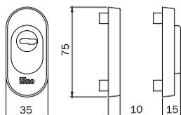
GHIERA MODULARE di protezione cilindro profilo europeo per MULTIBLINDO e BLINDO fissaggio dall'interno.
