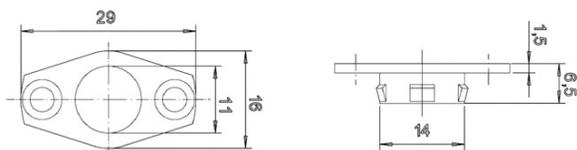
**Guida aste inferiore** per anta secondaria
