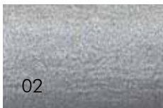
02 Metallisation arcspray process Metallizzato
