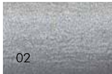
02 Metallisation arcspray process Metallizzato
