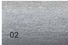
02 Metallisation arcspray process Metallizzato
