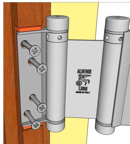
Posizionare la cerniera sullo stipite verificare che risulti in asse con la porta e quindi avvitarla verificando la tenuta delle viti.
