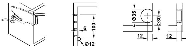
Per ulteriori misure di progettazione e per la misura Y far riferimento alle istruzioni di montaggio.
