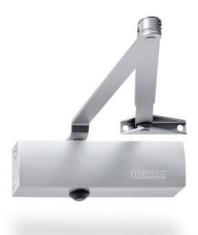
Chiudiporta aerei con braccio a V per porte a un'anta con larghezza dell'anta max. di 1100 mm con velocità di chiusura regolabile
