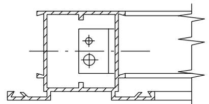
PROFILATI SPECIFICI PER PORTE A TAGLIO TERMICO OVE L'APPLICAZIONE DI UNA NORMALE GUIDA ASTE É RESA IMPOSSIBILE DALLA MANCANZA DI SPAZIO
