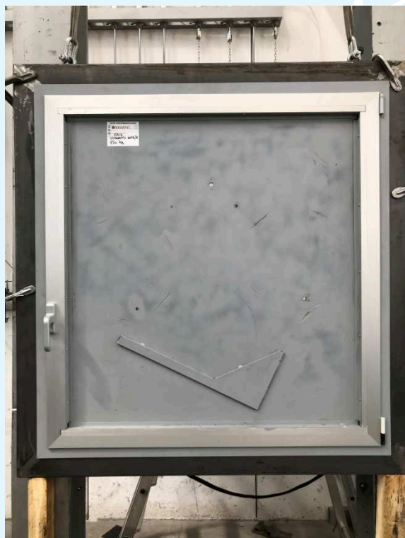
Fotografie del campione con anta a battente/ribalta (a destra zavorrato fino a 174 kg).
