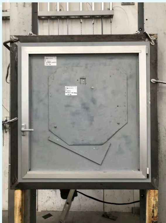
Fotografie del campione con anta a battente/ribalta (a destra zavorrato fino a 174 kg).
