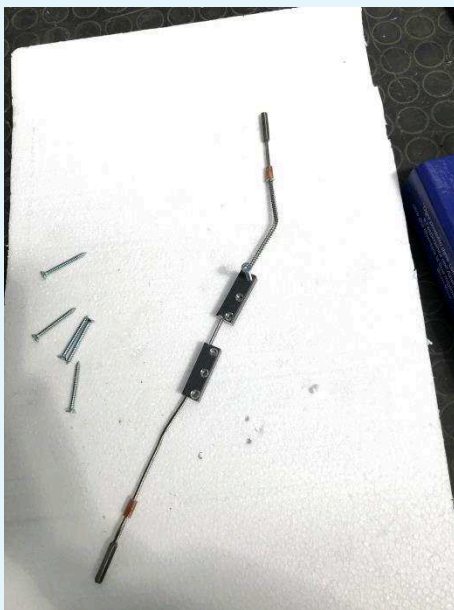
Fotografie del sistema di sicurezza dopo la prova con a battente/ribalta (peso 174 kg).
