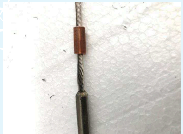
Fotografie del sistema di sicurezza dopo la prova con a battente/ribalta (peso 174 kg).
