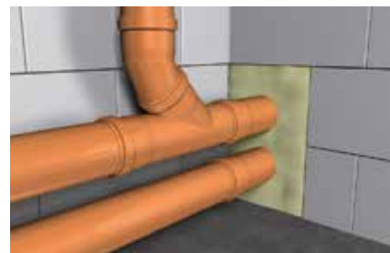
Riempimento di attraversamenti di tubazioni
