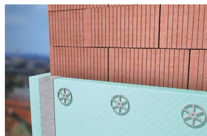
Dettaglio: incollaggio di pannelli isolanti
