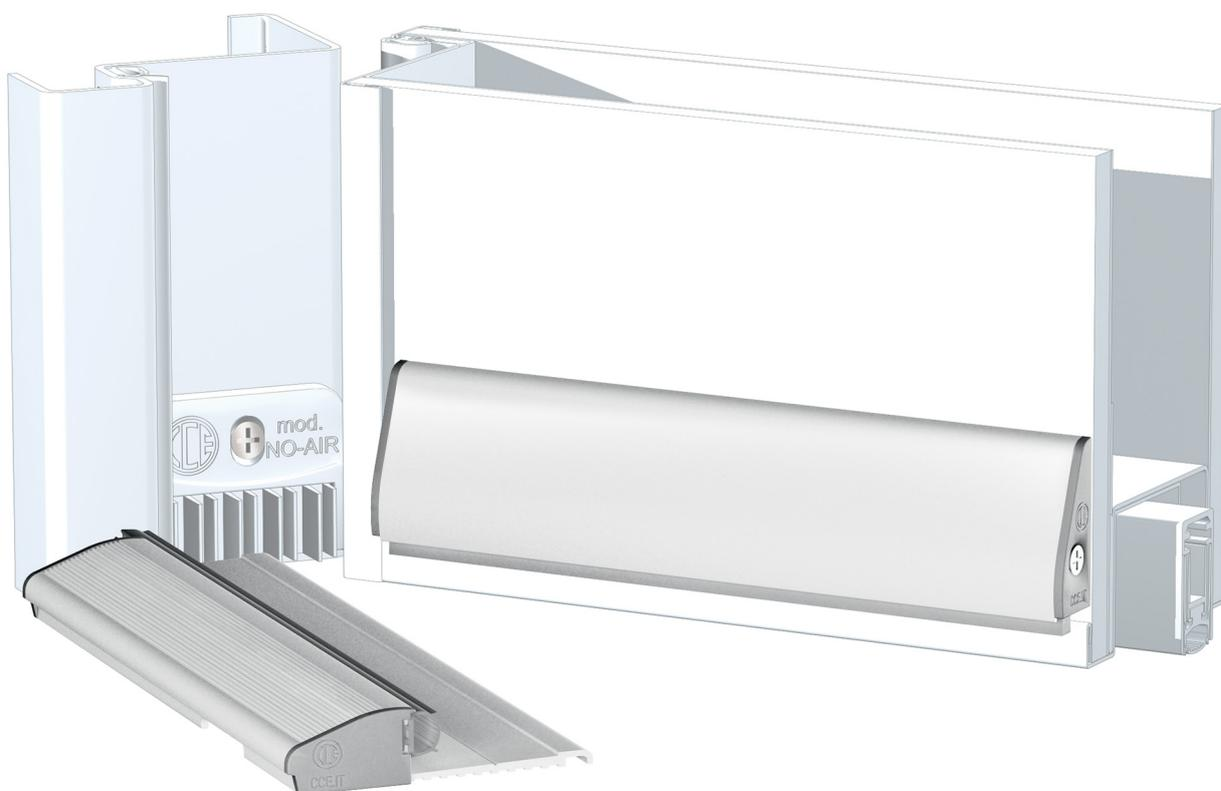
**IT** Sistema ideato per l'installazione anche su porte già esistenti dove sia necessario inserire una soglia drenante. La soglia Ulisse Light va in battuta sull'anta della porta con una morbida guarnizione in silicone autoestinguente. Il sistema può essere completato con l'utilizzo del gocciolatoio Ulisse Drip che grazie alla spazzola in polipropilene con pinna contribuisce ad aumentare la tenuta all'acqua.
