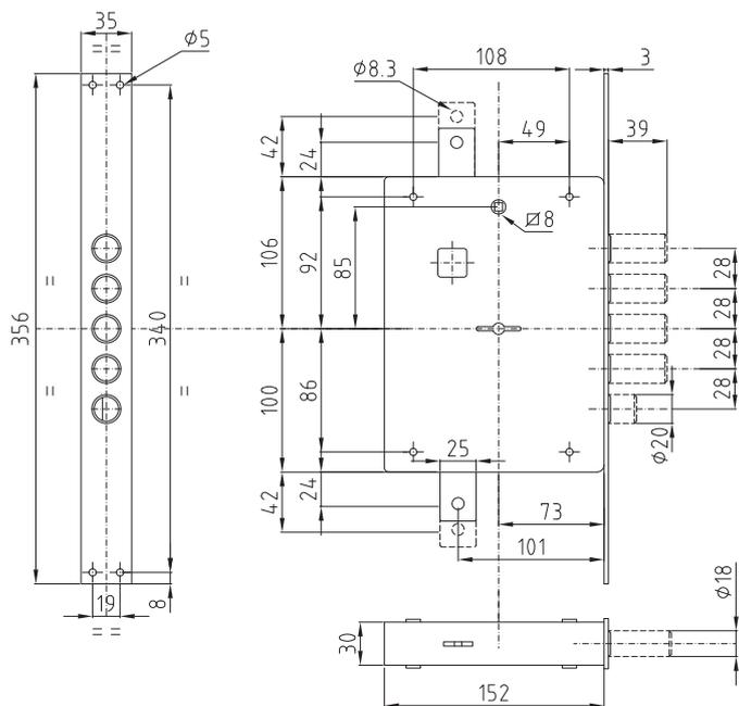
**SERRATURA AD INFILARE TRIPLICE
