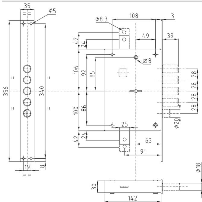
**SERRATURA AD INFILARE TRIPLICE
