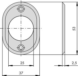
• Borchia in ottone burattato da abbinare a cilindri da applicare versione a tubo (diametro 25 mm.)
