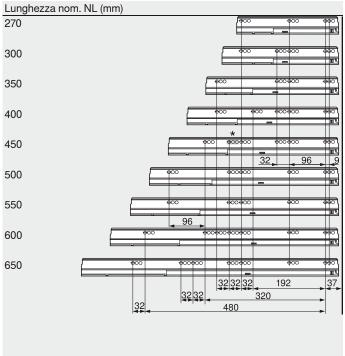
Dimensionamento per pannelli in truciolare da 16 mm
