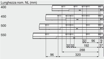
Dimensionamento per pannelli in truciolare da 16 mm
