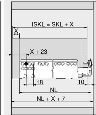
\* +1 mm in caso di montaggio della guida prima di assemblare il corpo mobile
