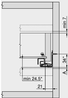
A Tenere la foratura spostata verso l'alto di 3 mm per intercambiare con l'estrazione totale
