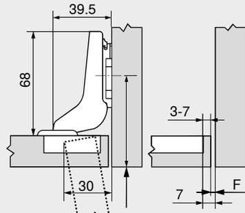
Arretrare la posizione di fissaggio della piastrina di premontaggio dello spessore del frontale FD +1.5 mm
