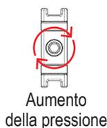
Inserire nel foro centrale del corpo dello scrocco a rullo una chiave esagonale di 3 mm. Avvitando, (senso orario) lo scrocco a rullo esce e si aumenta la tenuta e viceversa.
