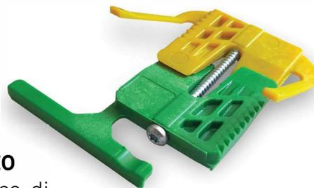
**IL CUNEO DOOR BLOCK®** è equipaggiato di una vite autofilettante con attacco **Torx15**, che collega due semi-cunei. avvitando la vite si determina una semi-rotazione ed espansione del cuneo.
