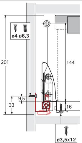
Posizioni di foratura per dispositivo di fissaggio del frontale
