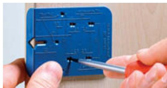
Dima di centraggio per basette a croce con fissaggio a viti e viti per pannelli premontate per battuta centrale
