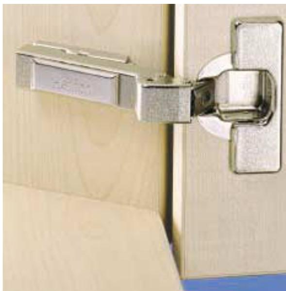
Cerniere con molla, montaggio a scatto e applicazione dello scodellino senza utensili, azione limitata della molla, regolazione incorporata del sormonto e regolazione della profondità a eccentrico.
