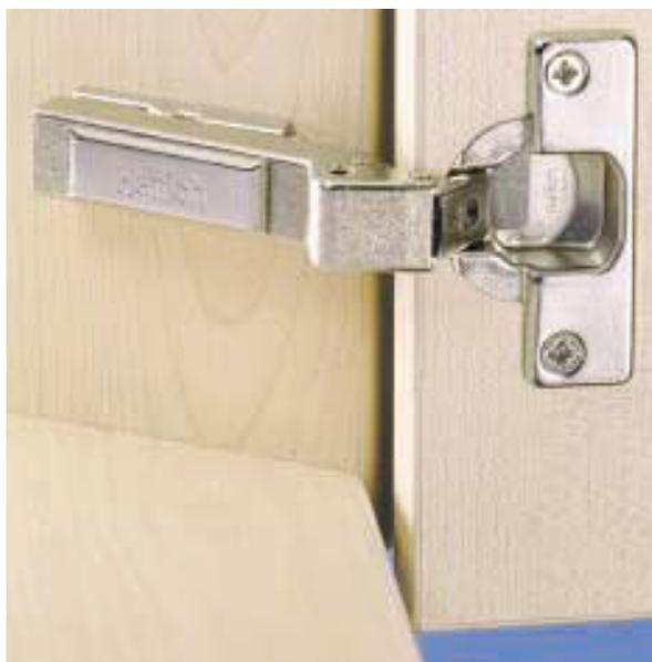
Cerniere con molla, montaggio a scatto, azione limitata della molla, regolazione incorporata del sormonto e regolazione della profondità a eccentrico.
