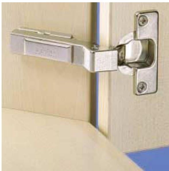
Cerniere con molla, montaggio a scatto, azione limitata della molla, regolazione incorporata del sormonto e regolazione della profondità a eccentrico. Angolo di apertura 95°, diametro scodellino 35 mm
