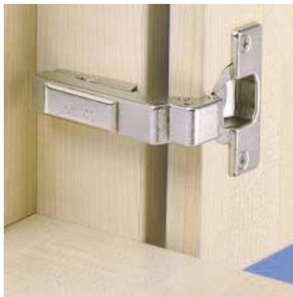
Cerniere con molla, montaggio a scatto, azione limitata della molla, regolazione incorporata del sormonto e regolazione della fuga a eccentrico.
