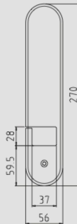
Al fine di evitare un deterioramento della finitura si consiglia di ricavare il secondo foro vite forando dal retro
