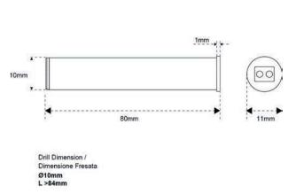
Sensore a infrarosso per accensione e spegnimento, installazione a incasso, disponibile in versione 12V o 24V.
