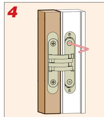
Montaggio cerniera nello stipite; vite testa svasata, brugola inserite nel kit
