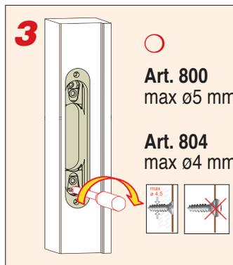
Montaggio della basetta regolabile nello stipite; **importante:** vite autofilettante testa svasata piana ○
