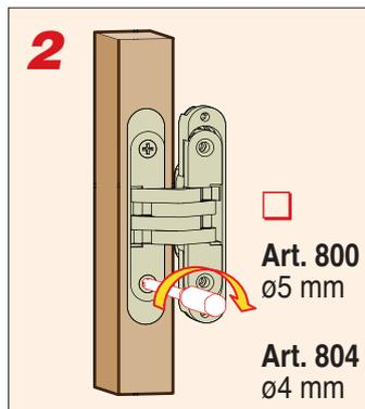
Montaggio della basetta fissa e della cerniera nella porta; vite autofilettante testa svasata piana □
