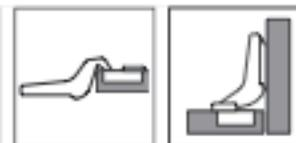
Utilizzare cerniere per battute mediane e piastrelle di premontaggio con distanziale da 9 mm
